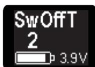
Die Zeit bis zum automatischen Abschalten des AT kann zwischen 1 Minute und 60 Minuten gewählt werden. Wir empfehlen, eine Abschaltzeit von 2 oder 5 Minuten. Das Gerät ist beim Betätigen des Feuertasters stets sofort dampfbereit, es sei denn,
