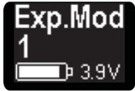
Der Akkuträger kann in 5 verschiedenen Betriebsmodi benutzt werden. Um das Menü möglichst übersichtlich zu halten, werden 3 der 5 Modi erst verfügbar, wenn der Expert Mode im Mod-Menü des Extended Functions Menu gesetzt ist.
