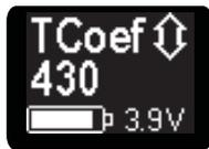
Die Wahl des richtigen Temperaturkoeffizienten ist wichtig für die korrekte Arbeitsweise bei temperaturgeregeltem Dampfen. Sobald temperaturgeregeltes Dampfen aktiviert wird, folgt eine Auswahlliste des Drahtsorte mit vordefinierten
