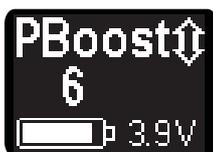
Wir empfehlen beim periodischen Boost die Nennleistung auf einen deutlich kleineren Wert zu stellen, als wenn ohne Power Boost gedampft wird, da anderenfalls die eingebrachte Gesamtleistung recht hoch ist und eine hohe Temperatur erreicht wird.
