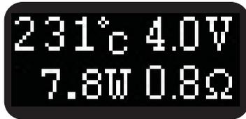
Aktuelle Akkuspannung beim Dampfen also inklusive etwaiger Einbrüche (drop).
